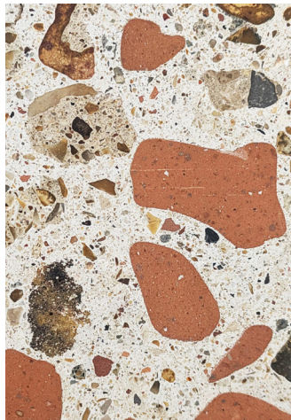
Béton brique & gravat recyclé
