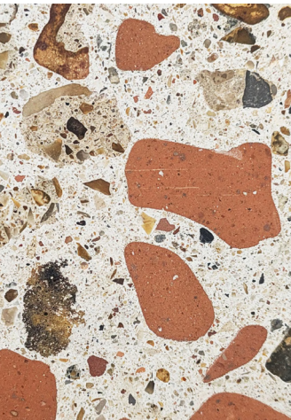
Béton brique & gravat recyclée
